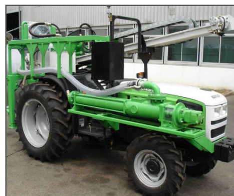
Pompe d'injection à vis
