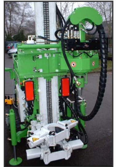
Tête de roto-percussion avec effacement
