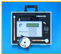
Contrôle d'intégrité des pieux
