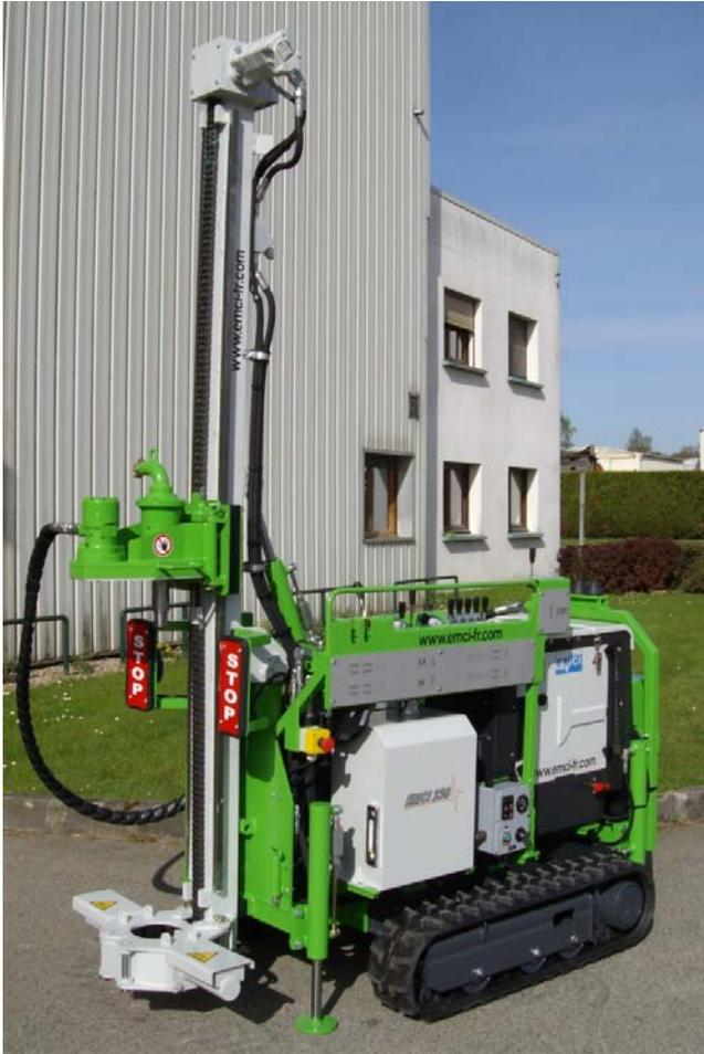
La sondeuse Modèle 230 est une sondeuse géotechnique légère, montée sur chenillard autotracté de largeur variable, dédiée à la géotechnique à faible profondeur, pour forage rotatif, carottage, ou tarière continue pour essai pressiométrique.
